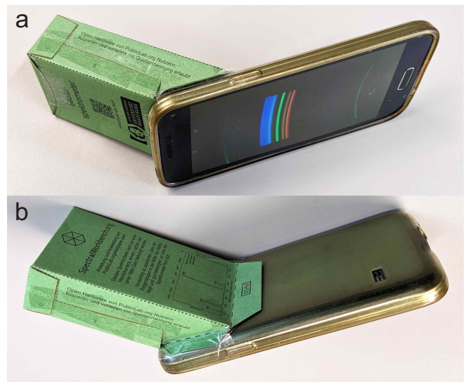
FIG. 2. Fotografien eines fertig zusammengebauten Selbstbau-Spektrometers mit justiertem Smartphone von zwei Seiten. Auf dem Smartphone-Bildschirm ist das Spektrum einer Leuchtstoffröhre zu erkennen. Der Spalt befindet sich links hinten am Spektrometer und ist auf diesen Fotos nicht zu sehen.
